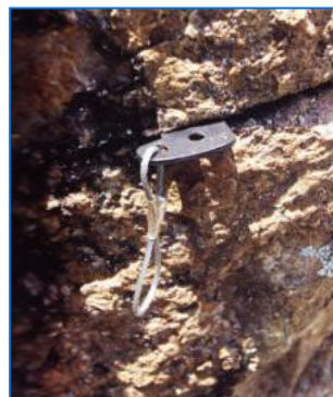
نمایی از کارگذاری مناسب یک RURP
