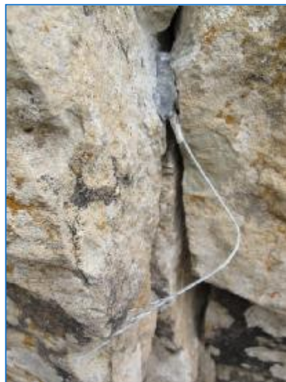
ابزار کاپرهد قبل و بعد از کوبیده شدن در داخل شکاف
