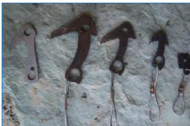
میکرو میخها با قابلیت خاص آنها جهت عبور از مناطق با شکافها و ترکهای ریز بر روی سنگ
