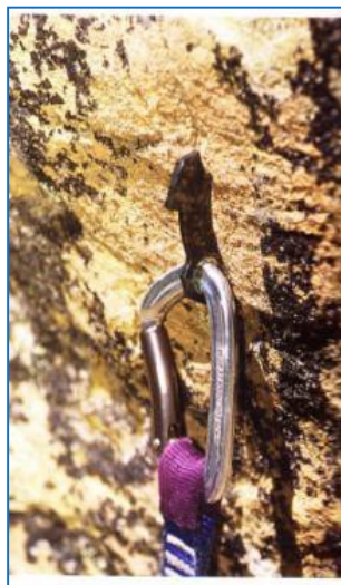
یک پکر که به صورت کاملاً مطمئناً کار گذاشته شده است
