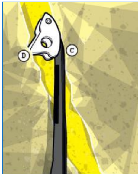
ترای کم و طرز صحیح کار گذاشتن آن
