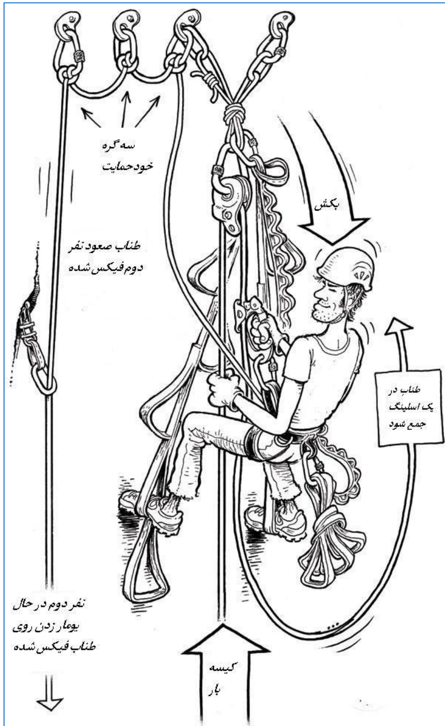
در شکل بالا معلوم است که نفر با استفاده از وزن خود و یک قرقره یکطرفه کیسه بار را به سمت بالا می کشد در حالیکه نفر دوم بر روی طناب ثابت شده در حال یومار زدن می باشد .
